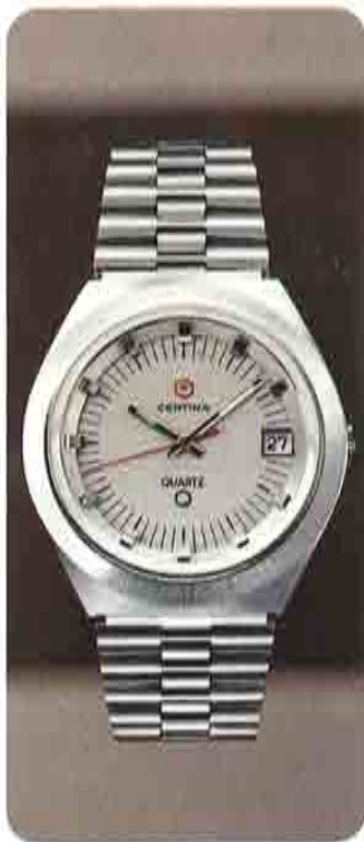
755 3517 41 Certina Quartz Elektronisches Hochpräzisionswerk mit Quarz-Resonator 32 768 Hz, stossicher, wasserdicht, Zentrumssekunde und Datum, antimagnetisch, gehartetes Mineralglas, verschiedene Leuchtzifferblätter nach Wahl Edelstahl oder Gelbgoldplaque Zuschlag für Stahlband Zuschlag für Plaqueband
