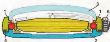
Il "movimento fluttuante" del Certina DS 1) giunti ammortizzatori - 2) fondo avvitato - 3) vetro infrangibile 4) giunto d'impermeabilità - 5) corona impermeabile
