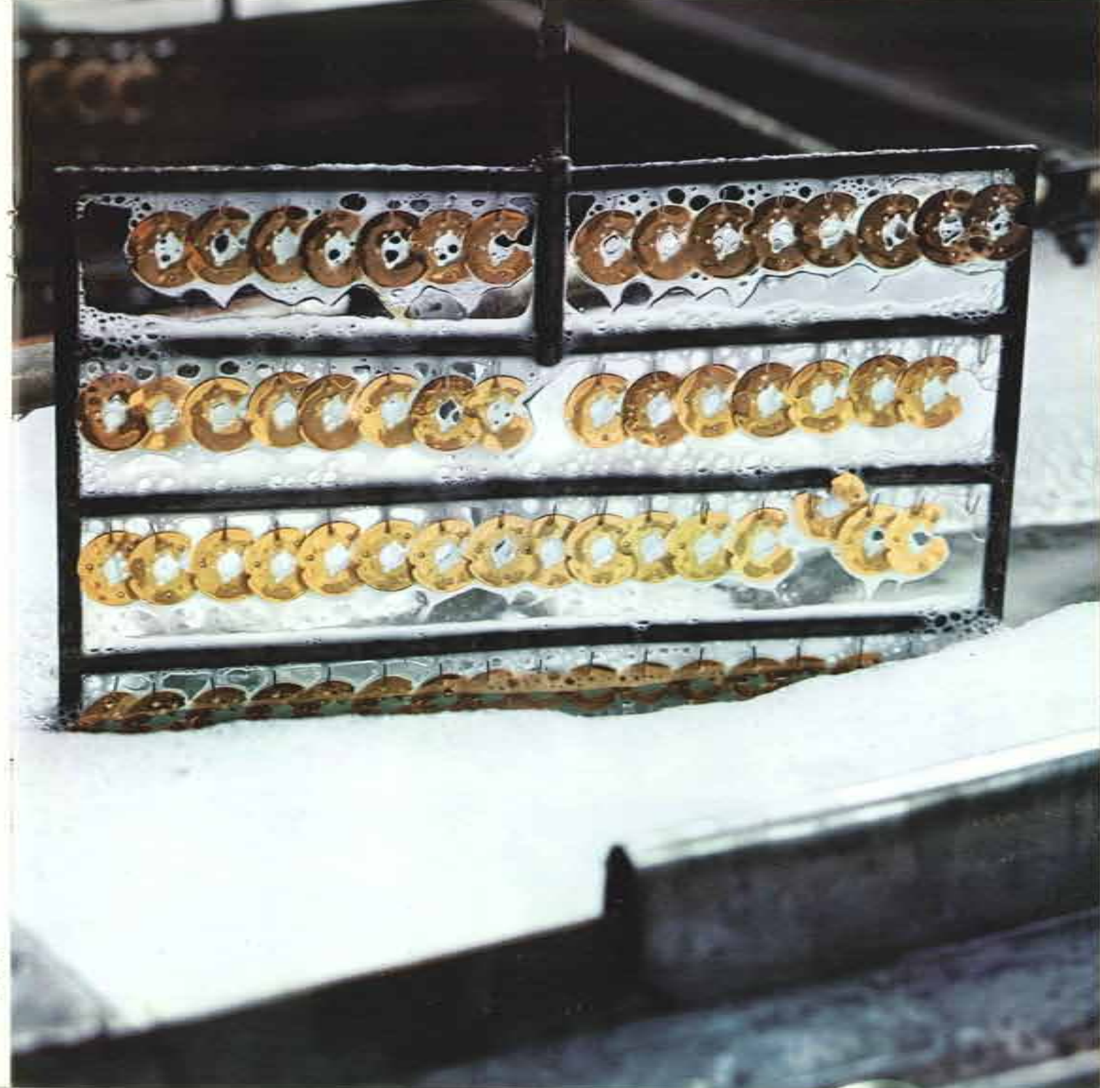
Vor der Veredelung werden die Bestandteile gründlich gereinigt und entfettet. Auf einem Rahmen sind die Teile des Rohwerkes sauberlich aufgezogen.
