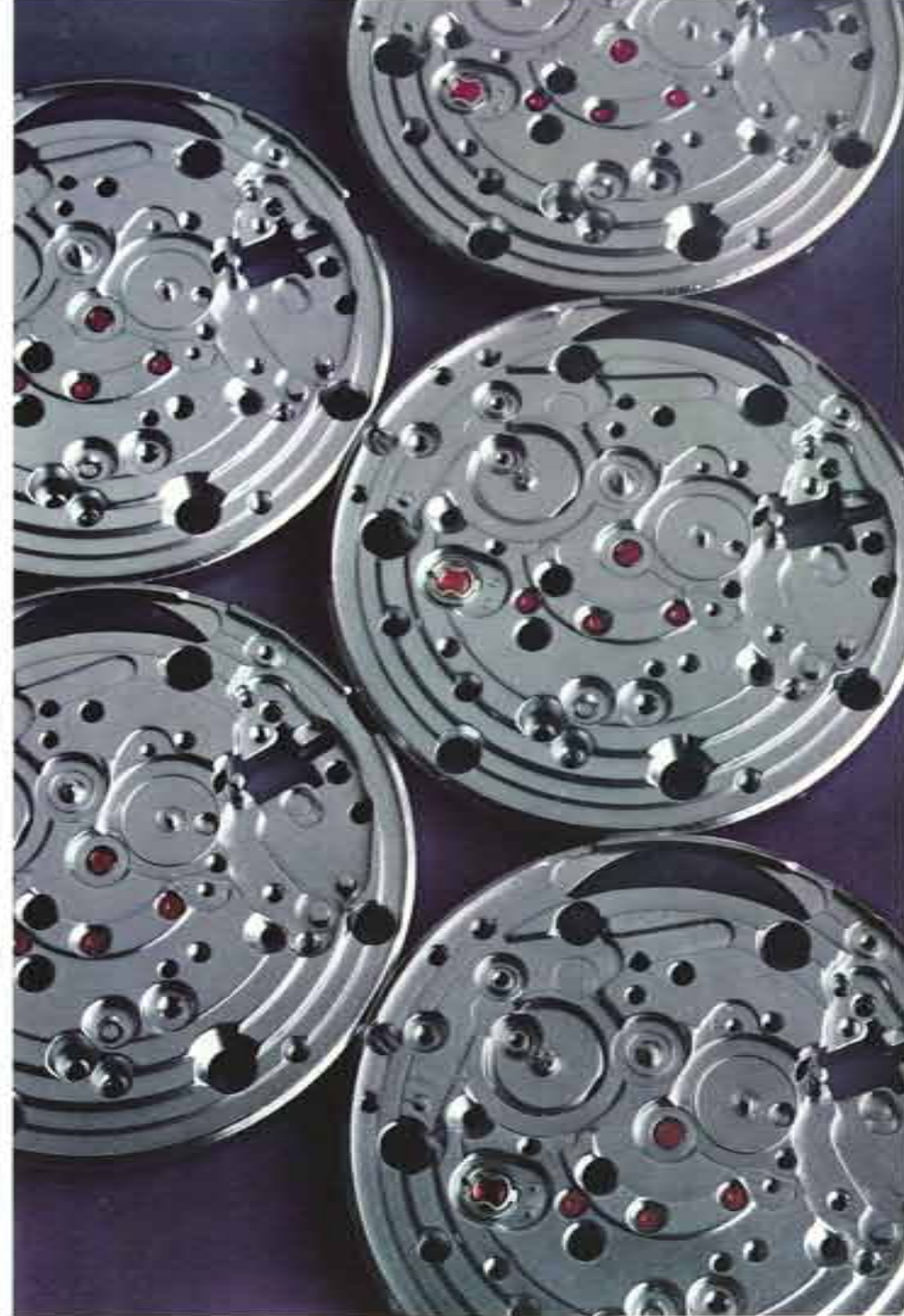
So sehen die fertigen Platinen nach 76 Arbeitsgängen aus.
