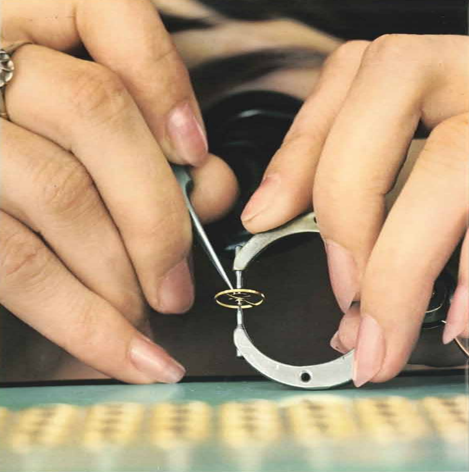
Wie riesig doch zwei Menschenhände wirken, die eine winzige Spiralfeder zentrieren und richten!
